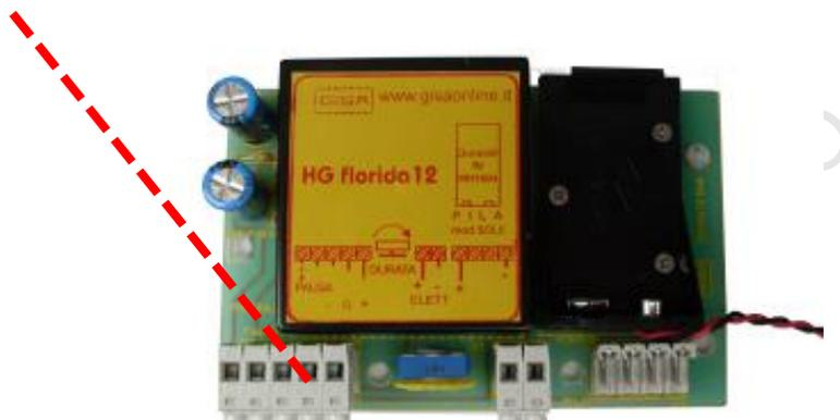
**OPERAZIONE D** - Estrarre e reinserire il morsetto della elettrovalvola ameno 5 volte.
