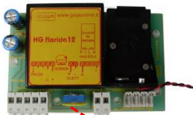
**OPERAZIONE B** - Ruotare rotellina del *trimmer* almeno 20 (venti) volte in senso orario e in senso antiorario fino ai fine corsa.
